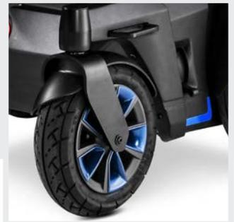
Die neuentwickelte Einzelradfederung (4-fach)
