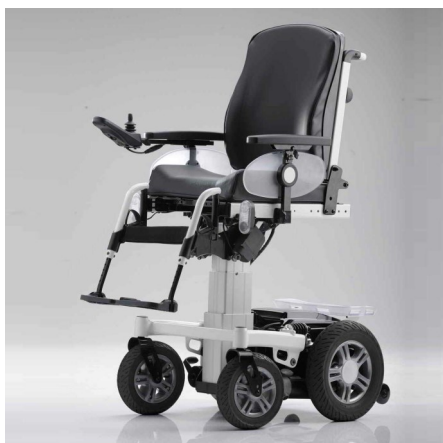
Ηλεκτρική ρύθμιση καθίσματος καθ' ύψος 300mm. 150Kg.
